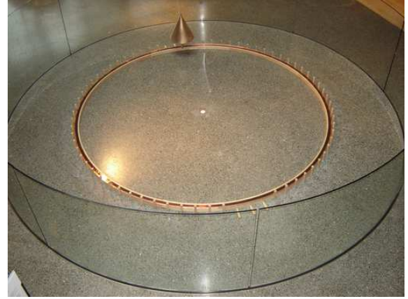
Mynd 9. Yfirlitsmynd af Foucault-pendúll Orkuveitu Reykjavíkur. Ytra þvermál spólustokksins er 2.70 m og markar sveifluviðd pendúlsins.
