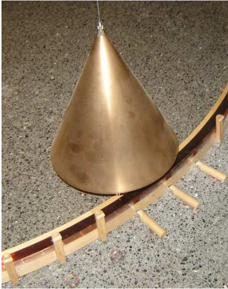
Mynd 10. Myndin sýnir hvernig vafningum, koparplötum, plastþynnum og fellipinum er komið fyrir á spólustokkunum. Seglastafinn fer hálfur út fyrir stokkbrún.
