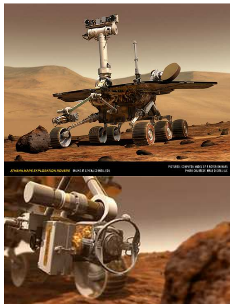
Mynd 8. Jepplingur á Mars. Efst má sjá tækjakostinn sem lýst er nánar í textanum og á neðri hlutanum sést þegar mælíbúnaður á arminum nálgast stein sem rannsaka á.
