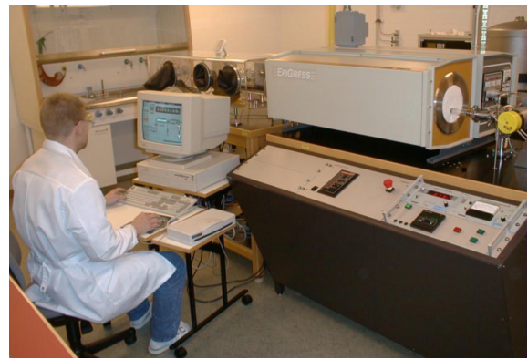
Mynd 4. Tækjabúnaður til ræktunar gallín–arsen húða úr vökvafasa.
